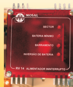
RV 14 Alimentador Ininterrupto
